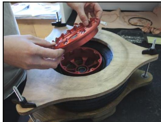
Positionner le flasque avec le joint torique sur l'autre partie de la roue dans l'outillage.
