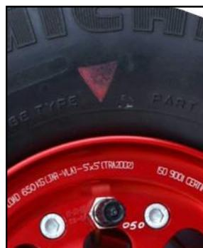
Pulvériser du lubrifiant à monter les pneus sur les flancs du pneu.
