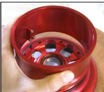
Positionner l'entretoise de la jante comme et appuyer avec la main. Vérifier que le tube et le flasque de jante sont en contact.
