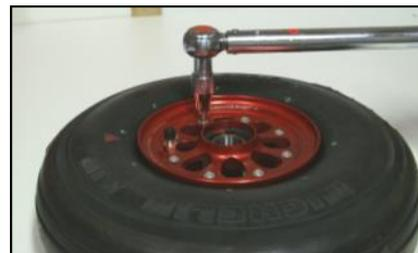
Serrer à 10N.m (+-1Nm) équivalent à 1m.kg (+-0.1m.kg) Puis serrer une seconde fois chaque vis à 10N.m .
